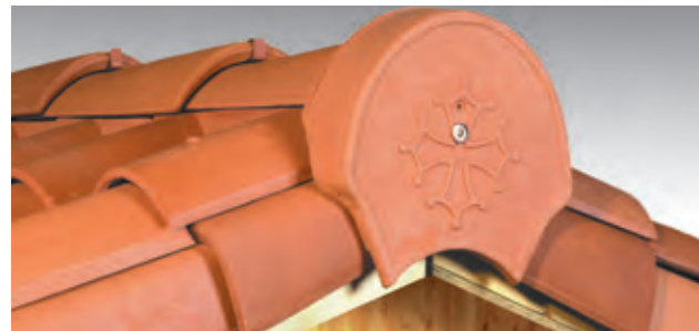
Emploi des tuiles sous-faîtières 2/3 pureau et rives rondes individuelles droite et gauche. Fixation du fronton par vis et rondelle d'étanchéité.
