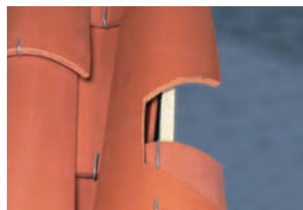
Fixation des tuiles de couvert en rive latérale gauche et droite par crochets «S» à raison de : 1 crochet «S» sur 2 tuiles.
