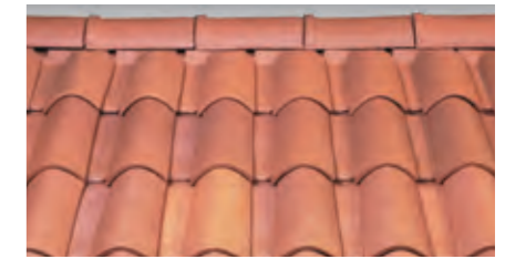
Faîtage réalisé à sec avec tuiles sous-faîtières 1/2 pureau et faîtières 1/2 rondes à emboîtement grand modèle, ne nécessitant pas d'étanchéité complémentaire, sauf protection neige poudreuse.
