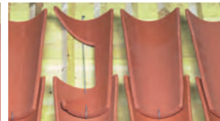
Fixation des tuiles de courant en plain carré par crochets long à œil à raison, sur 10 crochets 2 crochets longs à œil - Réf. CRCAN.550
