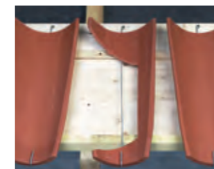
Fixation des tuiles de courant à tenons du 1er rang d'égout par crochets Réf. CRCAN.550. La fixation des crochets s'effectue facilement sur le support en égout ou sur les chevrons.
