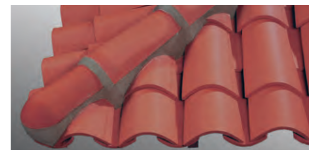
Tuile CANAL scellé au mortier (D.T.U. 40.22 art. 2.4).
