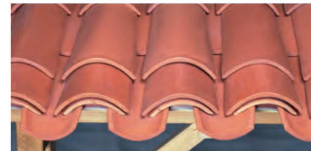
Mise en œuvre à 2 tuiles en pose à "joints décalés". Les tuiles CANAL Poudenx sont posées à recouvrement sur les sommets et dans les creux d'onde des plaques.
