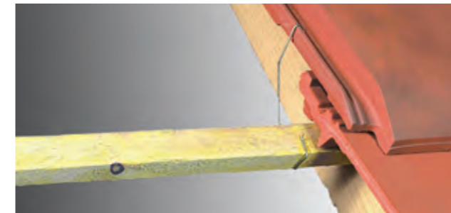
Fixation des tuiles en plain carré pour tenue au vent par crochet Mono* (le choix du crochet Mono dépend de la section du liteau) ou par crochet Harpon.
