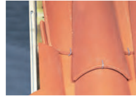
Fixation des tuiles du 1er rang d'égout en rives latérales gauche et droite, par crochets longs à œil - Réf. CRCAN.550
