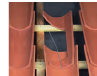
Fixation des tuiles de courant à tenons en plain carré par crochets - Réf. CRCAN.550. La fixation en référence au tableau n° 6 du DTU 40.22 art. 3.334 est assurée par les tenons des tuiles et par les crochets sur les liteaux à raison de : 1 tuile sur 5. La fixation des crochets s'effectue facilement sur les chevrons support des liteaux.
